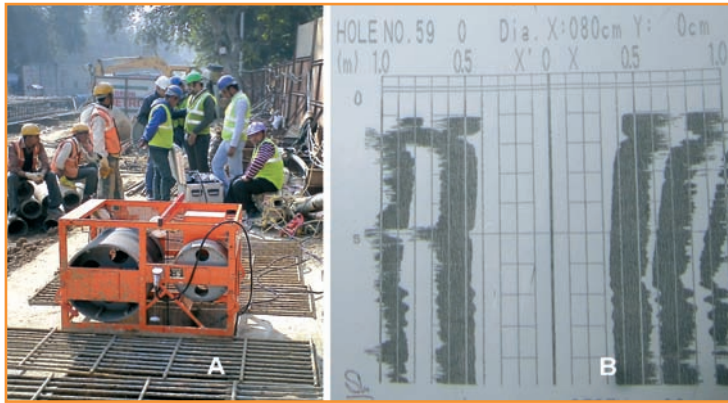
[Figura 6].- Registro Koden® de una sección de pantalla (A) y respectivo diagrama (B).
